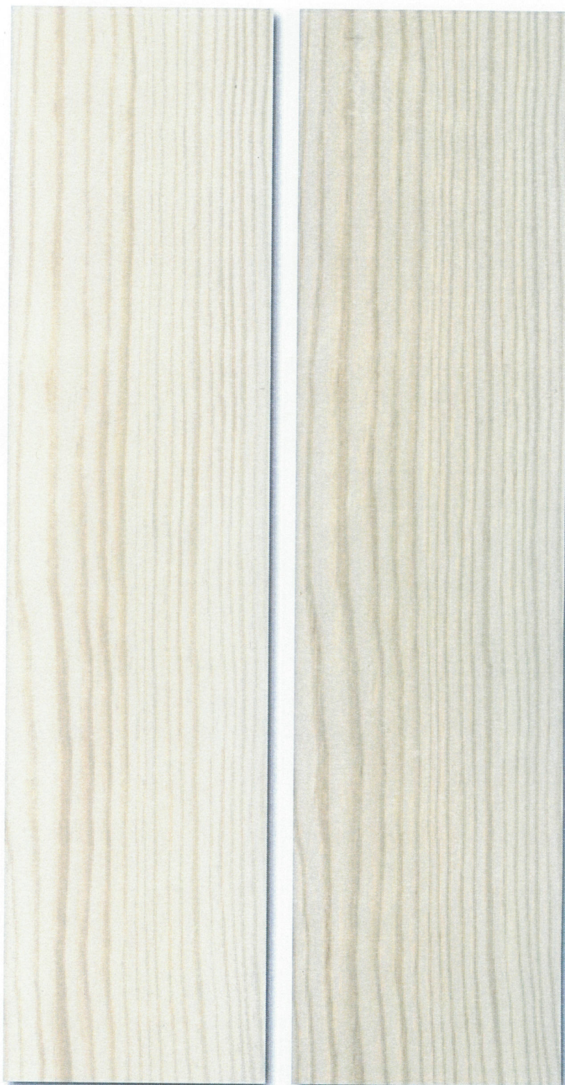
Abbildung 1: Probe 1 - Kiefer mit KaWaTech HMS9 beschichtet - unbewittert (links), nach 1 Jahr Freilandbewitterung (rechts)
